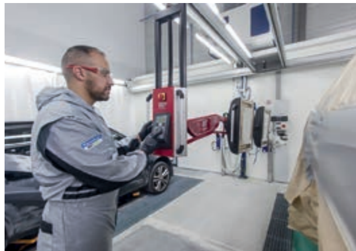
Une aire de préparation bien étudiée permet de travailler sur plusieurs véhicules en même temps : séchage UV/infrarouge...
