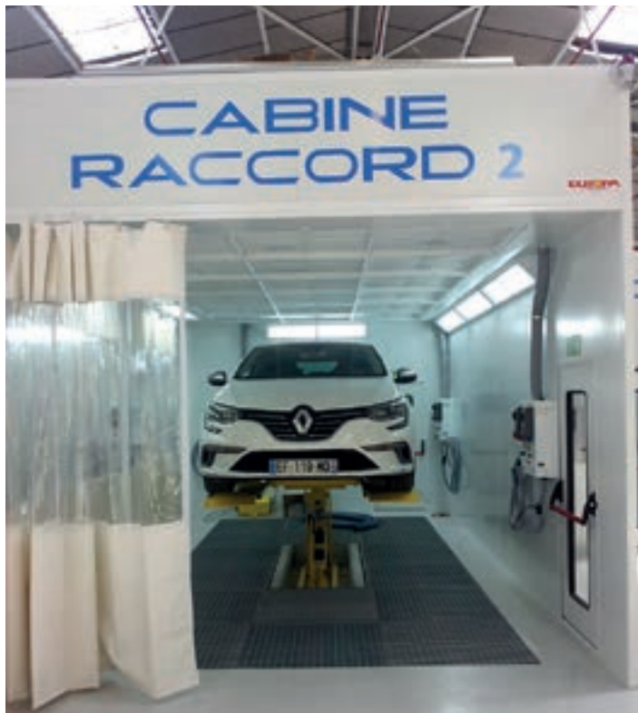
Les aires de préparation peuvent recevoir de multiples équipements en fonction des besoins de la carrosserie, comme des tables élévatoires ou des systèmes de séchage infrarouges ou ultraviolets.
