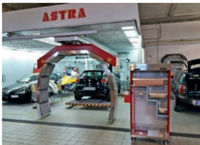
Le robot de séchage intégré à l'aire de préparation permet d'augmenter la rentabilité de l'atelier.
