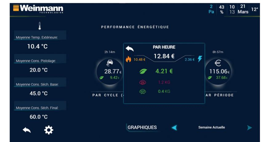
La nouvelle cabine AMIRAL I-Line est entièrement connectée et permet de suivre en temps réel les performances économiques et énergétiques (mesure du taux d'occupation, suivi des consommations gaz, suivi des émissions de CO<sub>2</sub>, etc.) afin de maîtriser les coûts et les consommations d'énergies. Une cabine intelligente qui offre des indicateurs inédits !
